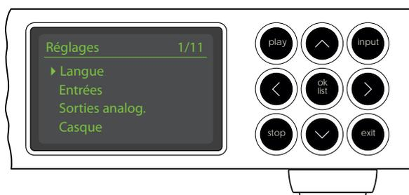
On entre en mode réglages en appuyant sur la touche **réglages** (⚙) de la télécommande ou en appuyant et maintenant enfoncé le bouton **ok/list** de la façade. Vous aurez ainsi accès à toutes les fonctions de réglage du NAC-N 172 XS.
