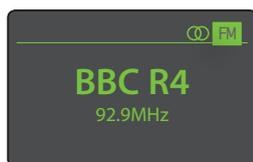
**Note:** L'icône des deux cercles emboîtés l'un dans l'autre dans le coin droit de l'écran indique un signal stéréo.
