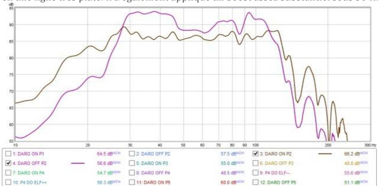
Le deuxième test était facile et DARO réussit. Ici, la réponse pré-EQ a un grand pic à 30 Hz et un creux à 55 Hz, suivi d'un autre pic à 70-80 Hz. Encore une fois, DARO montre qu'il est à la hauteur de la tâche, et encore une fois, nous voyons cette augmentation jusqu'aux fréquences les plus basses.
