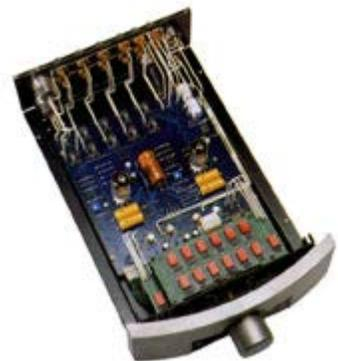
InControl est un préamplificateur à deux étages entièrement et intrinsèquement équilibrés, fonctionnant en pure classe A. InControl a été développée selon toutes les directives traditionnelles de Pathos : des tubes pour l'amplification de tension,
